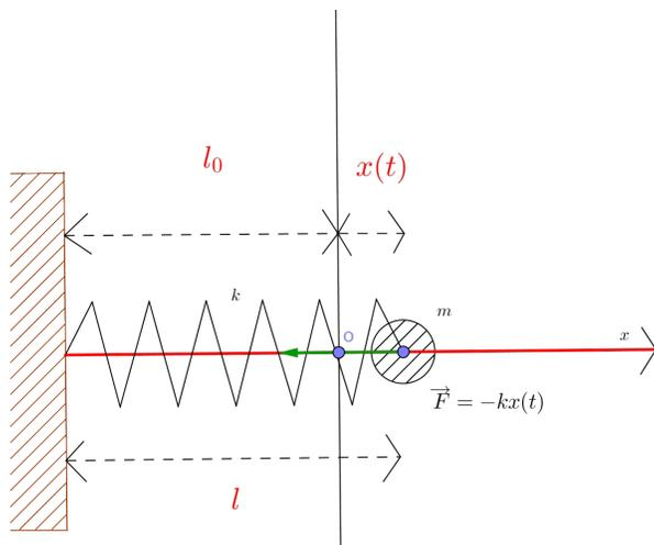
Un ressort de constante de raideur  $k > 0$  de longueur au repos  $l_0$  peut être étiré ou comprimé sur un axe perpendiculaire à la verticale du lieu, sur une longueur  $l(t)$ , où  $t$  est le temps mesuré par l'observateur. A l'extrémité du ressort se trouve une masse  $m$ . On suppose qu'au cours du déplacement cette masse n'est soumise qu'à la force  $\vec{F} = -kx(t)$  avec  $x(t) = l(t) - l_0$ . A l'instant initial  $t = 0$  on a  $x(0) = A > 0$ . (Physiquement, que cela signifie-t-il?)
